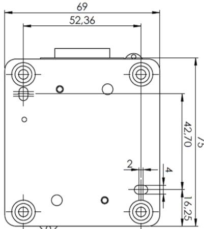
Montage: Kabelverschraubung nach unten
