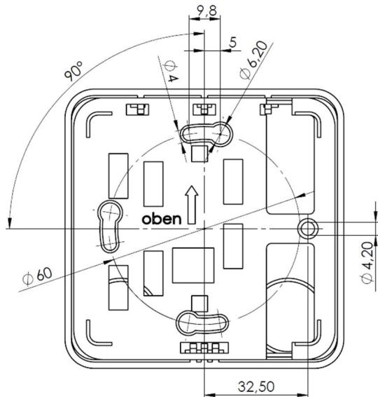
Die Konvektionsöffnungen müssen nach oben/unten ausgerichtet sein um eine Durchströmung mit Raumluft zu gewährleisten. (siehe Kennzeichnung Gehäuse Rückseite)
